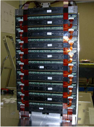
図 3.4: トラックモジュールの写真(左)と検出原理 [19]
