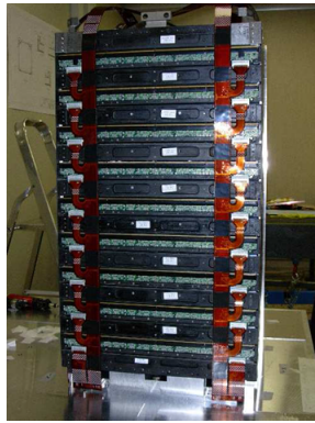
図 2.4: トラッカー部 (TKR) の写真 (左) とトラッカー部でのガンマ線の検出原理 (右) [33]
