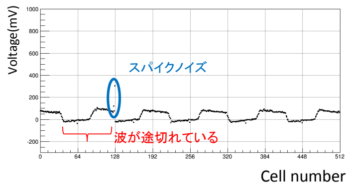
図 68: スパイクノイズの混入とデータ飛びの例
