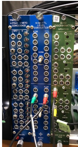
図 4.3.6: 中央の機器でファンクションジェネレータから出る TTL 信号を EASIROC の規格である NIM 信号に変換、右のディスクリミネーターで信号の幅を 90ns に調整した
