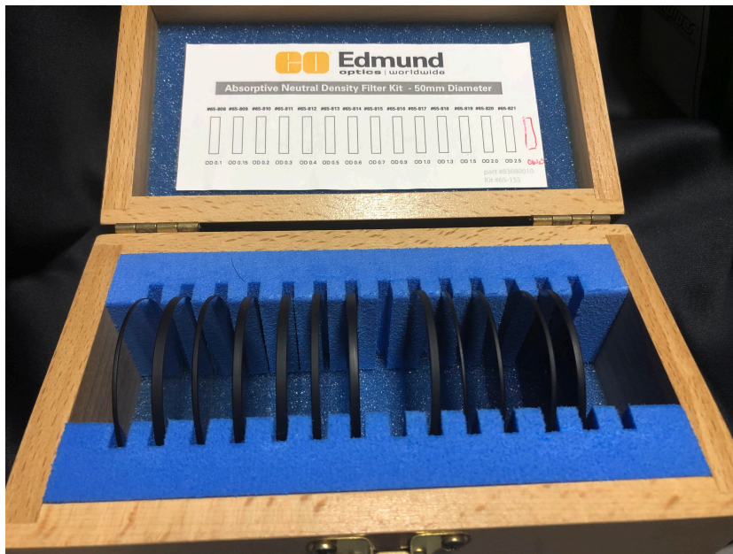
図 4.3.5: 使用する Edmund Optics 社 [27] の ND フィルター
